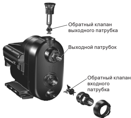
Рис. 20 Обратные клапаны входного и выходного патрубков
