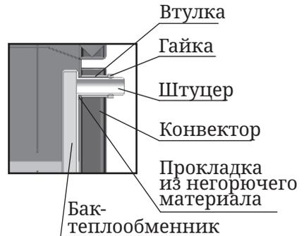
Рисунок 16. Демонтаж теплообменника
