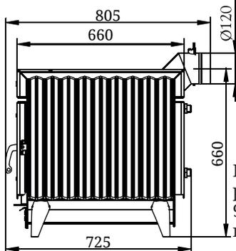
Рисунок 6. Габаритные размеры «Огонь-батарея 9Б» с выходом для трубы назад
