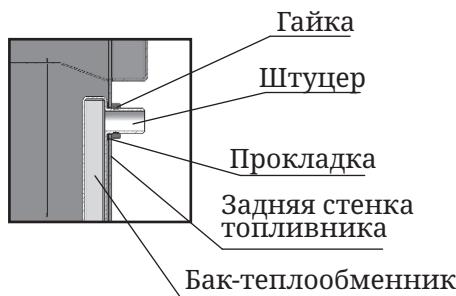
Рисунок 11. Демонтаж теплообменника
