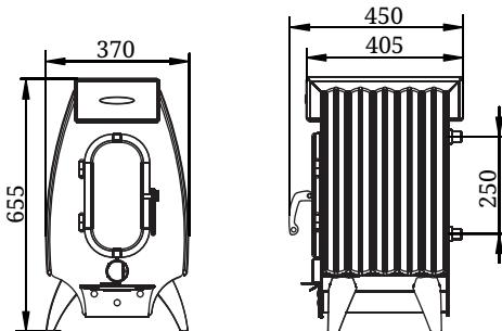
**Рисунок 1. Габаритные размеры
