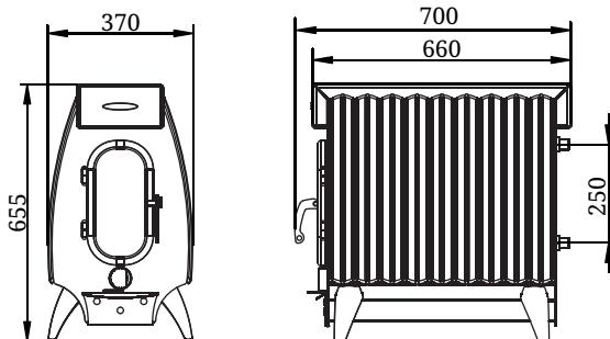
Рисунок 3. Габаритные размеры «Огонь-батарея 9Б Лайт»
