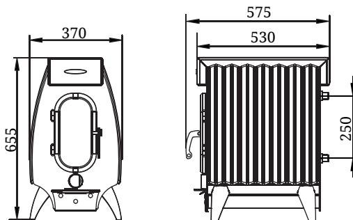
Рисунок 2. Габаритные размеры «Огонь-батарея 7Б Лайт»
